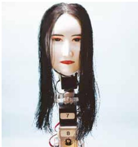
図2 人形浄瑠璃の所作と人の感情を深層学習したAI人型ロボットの頭部
