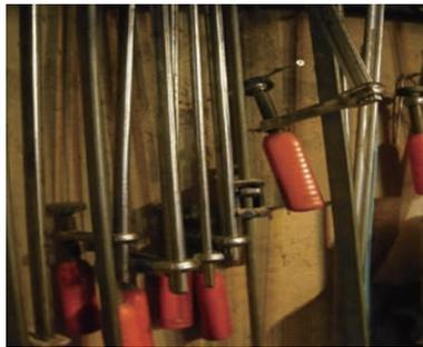
かに入ると壁にたくさんのクランプ（作業するとき、材が動かぬよう押さえる道具）が吊るしてある。台の上には使いかけの鉋かんと鑿のみ、金槌、仕上げに塗るオイルの入った丸いケース。オイルは材の水分が蒸発するのを防ぎ、くるいをでにくくする。材を乾燥させるための部屋にはヒノキの板材が寝かせてあり、暖かな部屋いっぱい木香が満ちていた。
