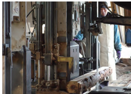
作業のようす。スギやヒノキなどの丸太の機械に取り付け、木肌を削ぐように切っていく
