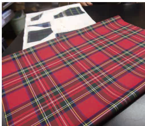
海外の傘を再現するためにつくられた生地。糸の本数や密度を調整することで実物に近いものになる
