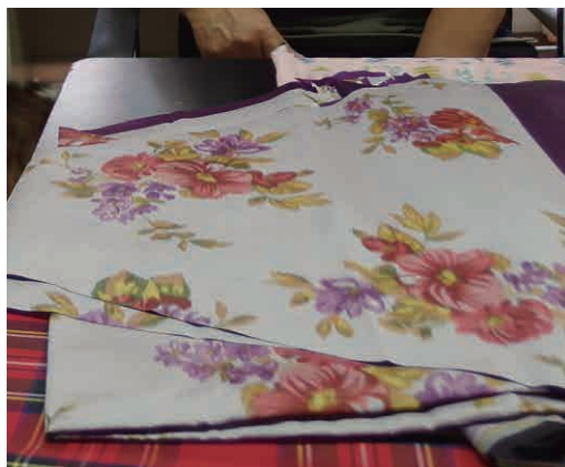
傘に使う形に裁断されたほぐし織の生地。ほぐし織の「ほぐし」というのは、生地を織る際に色づけによって固まった糸をほぐしながら織ることから呼ばれる
