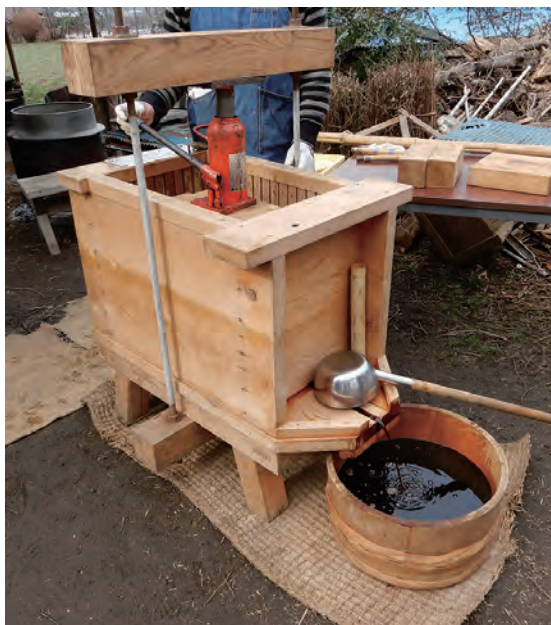
艘の全体像。本体部分や土台にわかれており、組み立ててから使用する
