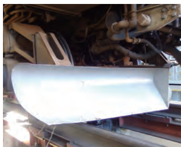
車両下部に設置されている雪よけ。これで雪をかきわけながら前進することができる
