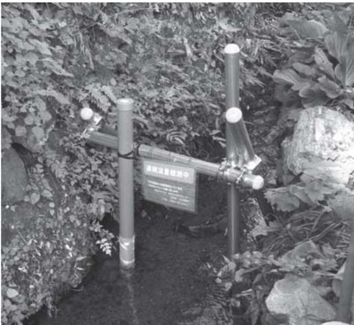
図2. 水圧式自記水位計設置状況
